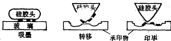
图 1-5 间接丝印油墨转印
