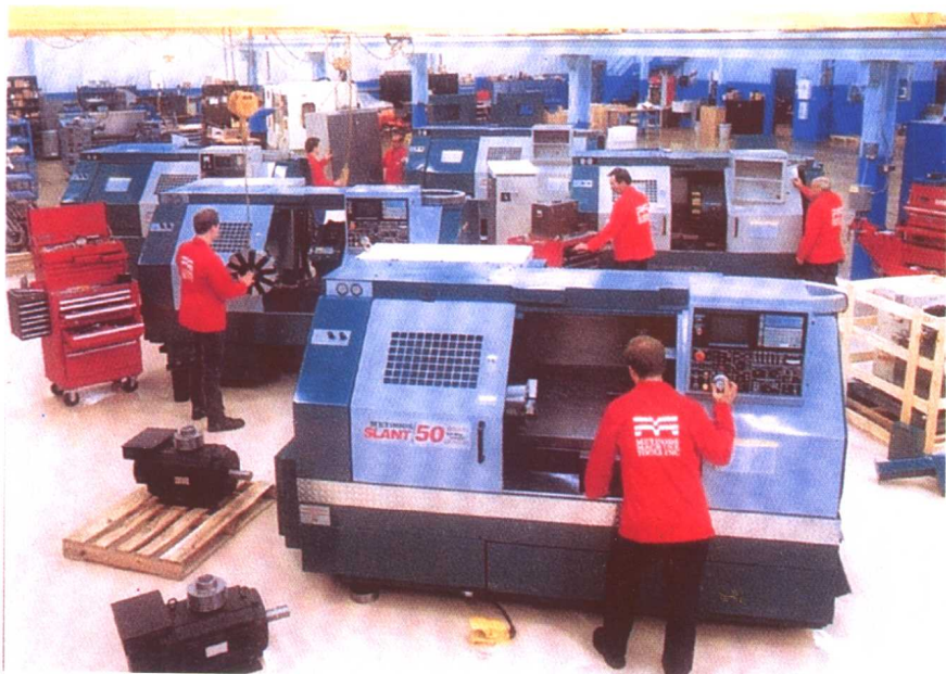
MJ-50CNC 车床在美国安装调试
