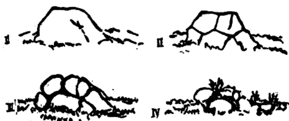
图1-2 岩石机械分解的几个阶段示意图
