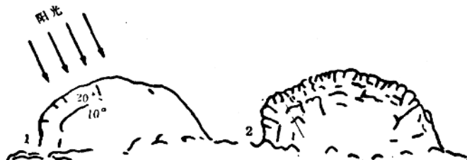
图1-1 在温度变化下岩石表面剥落阶段示意图
