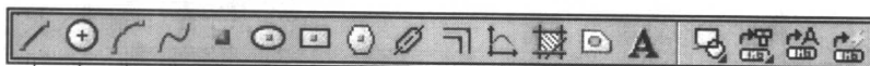
直线 圆 圆弧 样条 点 椭圆 矩形 正多边形 中心线 等距线 公式曲线 剖面线 填充 文字 块生成 提取图幅 技术要求库 构件库
