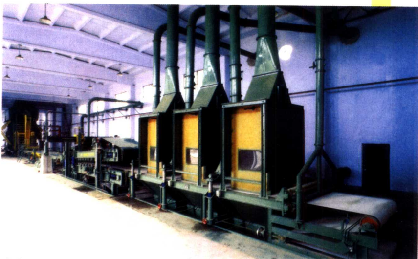
建在四川洪雅的 110m 3 /day 中纤板生产线
