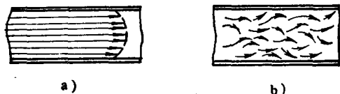
图 4 流体在管内流动的两种状态
