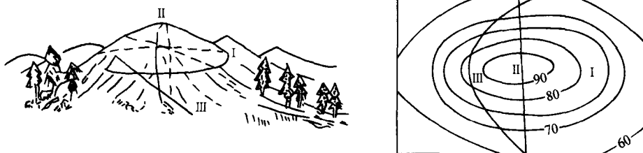
图 1-3 岩层露头线及其水平投影（右为平面图，图中数字表示等高线高度）
