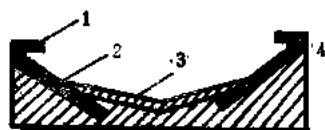
1. 防逃墙 2. 堤坡及护坡 3. 泥沙层 4. 池底
