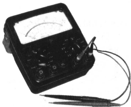
图 1-1 模拟式万用表的外形结构
