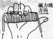
图1-2 通电螺线管的右手定则
