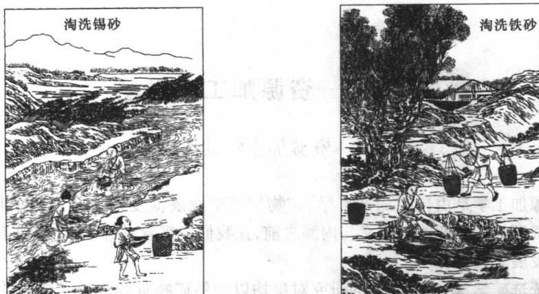
图 1-1 《天工开物》一书中的插图：淘洗锡砂和淘洗铁砂
