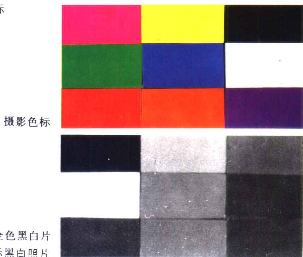
图7 摄影色标（加用滤色镜）（灰条表示未加色镜各色在黑白照片上所呈灰阶，各圆点表示加用黄、蓝、绿黄、橙、红色镜后各色在黑白照片上所呈灰阶）
