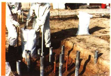
图为野外试验结束后回挖每个试验坑污染土壤。图中钢管是每次取土芯柱后压入的回填管，从图中还可见到埋置的负压计。回收的污染土壤运回中辐院实验室作植物栽培实验。
