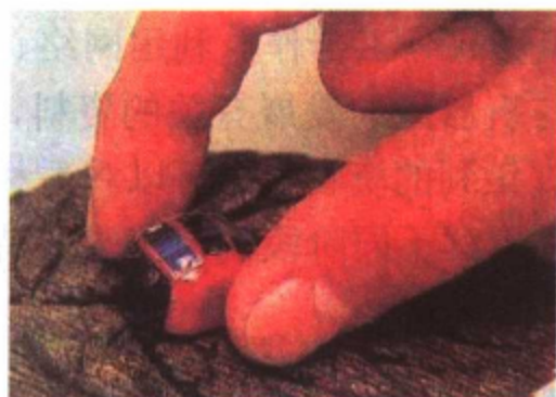
这是一只仿照甲虫外形制造的微型机器人，在它的背上镶有太阳能电池板
