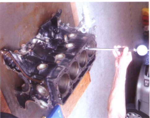
图2-1 用量缸表检查缸径
