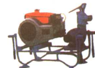
ZB35-12水泵机组
