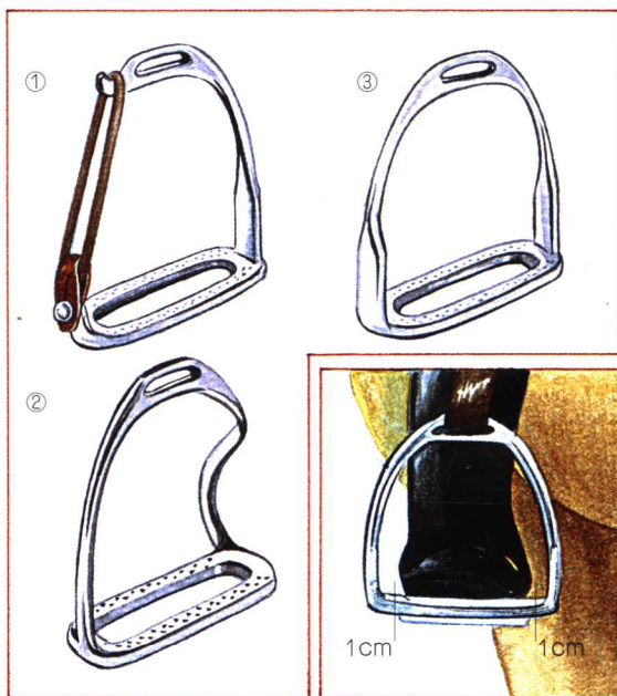
安全马镫（图①，②）脚能自由滑脱。一个大小合适的标准马镫（图③）应比马靴宽2cm，以使马靴能轻松穿上。
