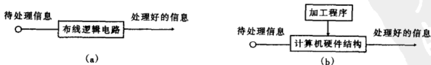
图 1—2 硬件远动装置和软件化远动装置的区别
