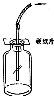
图 1-3 向上排空气集气法
