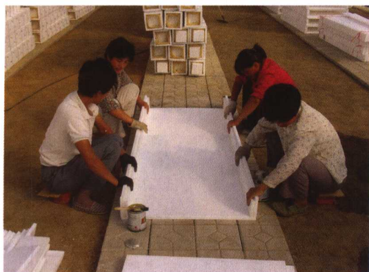
用聚苯乙烯泡沫塑料板自制深水培栽培槽
