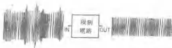
第 3 圖 振幅性雜音經限制電路切除
