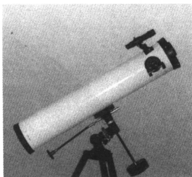
图 1.2.3 牛顿式望远镜
