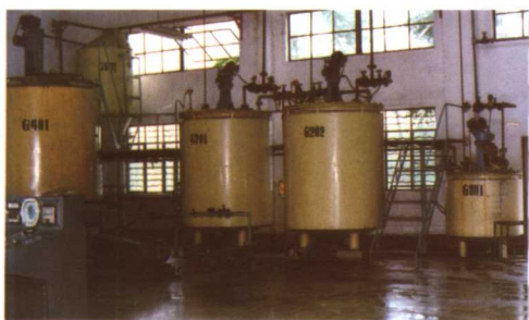
RHC - 100 型乳化沥青生产成套设备
