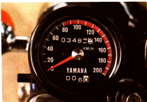
機車的速度表，由於沒有方向的表示，因此實際上只是指示速率的儀表。
