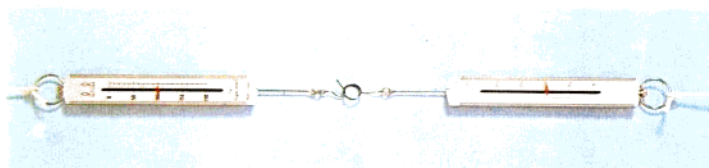
拉力的平衡，大小相等、方向相反的二力平衡。
