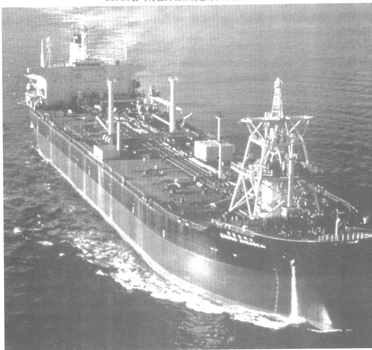
图 1-10 SBS系统（我国南海西江油田“南海开拓者”号储油轮）
