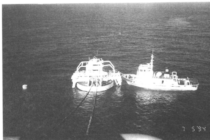
图 1-5 日本出光公司的一个CALM系统 也是最成功的一种单点类型。从一定意义上来说，其它许多类型的单点都是由此类单点的基本原理引申而成。如由SOFEC公司设计的在北也门建的一套名为FSU SAFER的单点(见图1-6)，就是CALM系统的一种延伸。这套系统实际上是由一艘油轮与一套CALM系统组合而成，只不过是把一套CALM系统安装在一艘油轮的船首下部而已。
