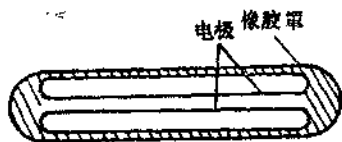
图5 皮带纵裂检测器构造
