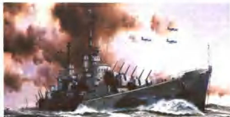
“圣胡安”号轻巡洋舰。排水量6000吨,航速32节,装有12门127毫米高平两用舰炮。
