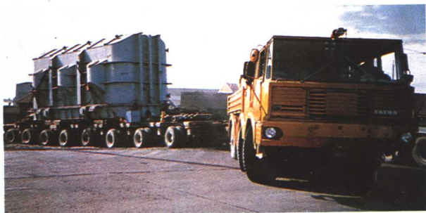
浙江省火电建设公司用 200 吨大型平板车将镇海发电厂一期工程的主变压器运抵工地
