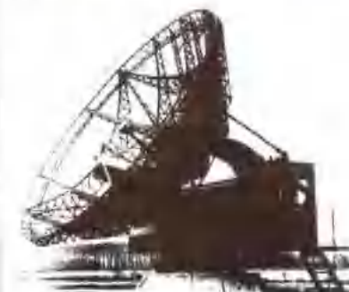
巨大的“维尔茨堡”雷达反射器,直径7米。
