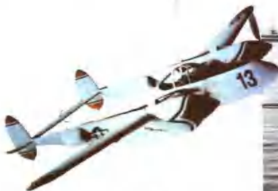
美国P-38“闪电”式战斗机是第二次世界大战中一种性能较好的高速活塞式战斗机。装有1门航炮和4挺机枪。
