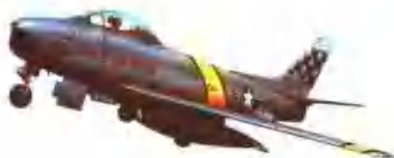
美国F-86D型战斗机。其机头装雷达罩。1948年,美国在F-86战斗机上开始采用后掠翼。
