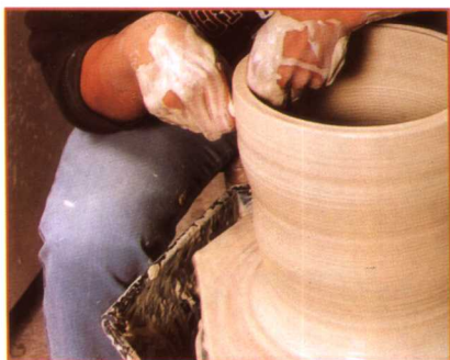
10. 左右手交替继续向上拉，同时保证坯壁的厚薄均匀。
