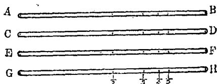
图 1—3 缩放尺的制法
