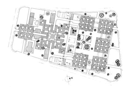
项目应用Taller建筑公司早期设计方案中的积木式体系。在空间上组合立方体使得没有任何两个相邻的住宅区是相同的。立方体的分布,无论是在设计还是在视图中,都严格遵循几何法则。在寻求多样性的基础上也避免造成任何建筑结构自发生长的感觉。
