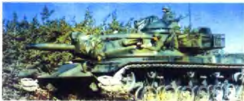
上图: M551 轻型坦克 用两用坦克炮发射“橡树棍” 反坦克导弹
