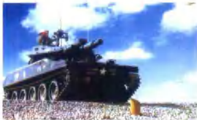
上图: M551 轻型坦克 用两用坦克炮发射“橡树棍” 反坦克导弹
