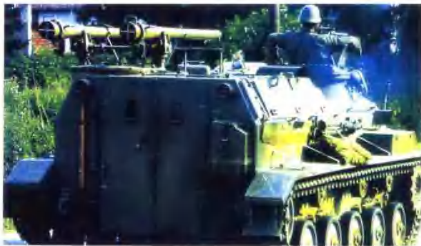
装在装甲车上的 M60 式 82 毫米无后坐力炮
