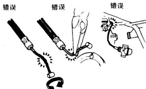
图 1-2 操纵钢索不得弯曲变形
