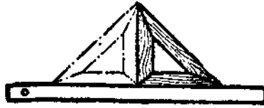
图 1.9 检查 90^\circ 角的方法
