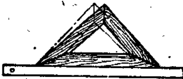
图 1.11 检查 45^\circ 角的方法
