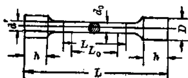
图 1 拉伸試驗所用的典型試样
