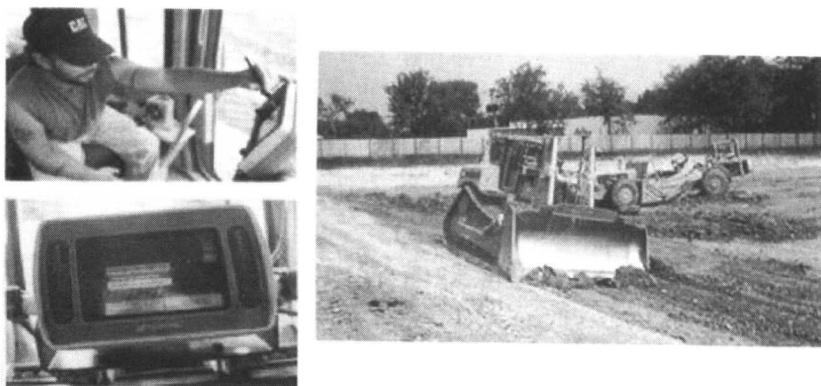
图 4 全球定位系统/机械控制的重型设备
