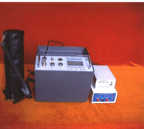
KBD5 煤与瓦斯突出（冲击地压）电磁辐射监测仪（便携式、适用于移动式监测）
