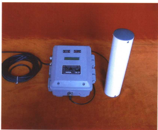
KBD7 煤岩动力灾害非接触电磁辐射监测仪（可与KJ系列煤矿安全监测系统联网运行）
