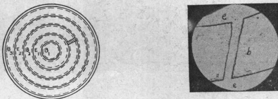
图1 光刻缺陷使发射区通过基区,反刻后 EB 短路(照片是缺陷区显示)。
