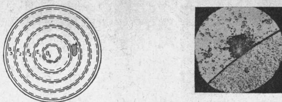
图5 结边缘的破坏点(照片是缺陷区显示)
