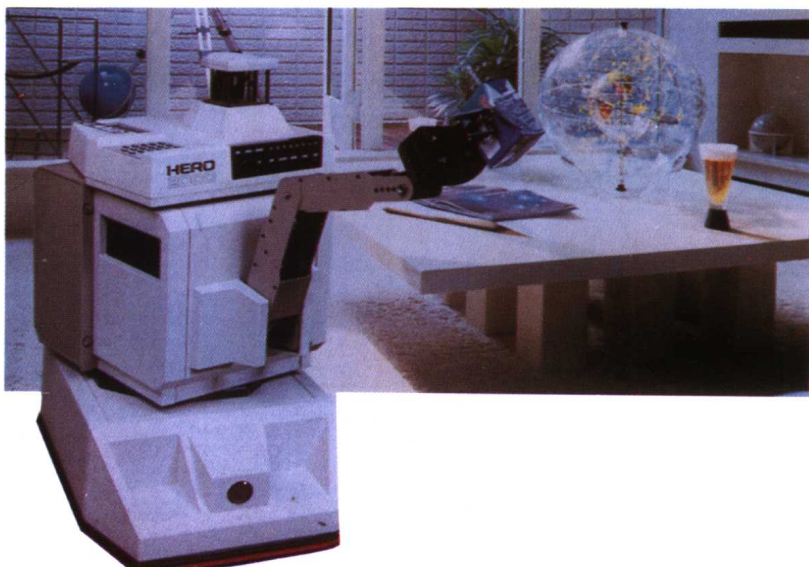
装有声纳的家用机器人“HERO-2000”号,它的下边是 360 度扫描声纳。
