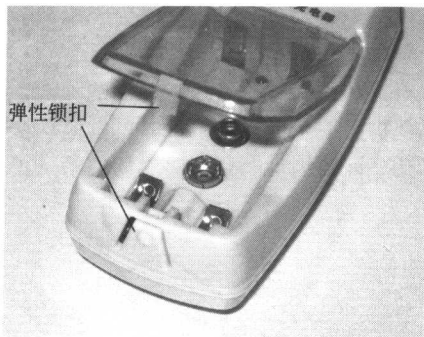
图 1-3 充电器的塑料弹性锁扣
