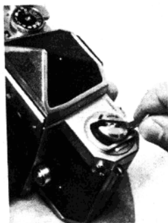
爲確定軟片捲纏正確，正捲軟片前用倒捲曲軸去 掉弛緊。當使用扳片桿時，曲軸應該轉動。
