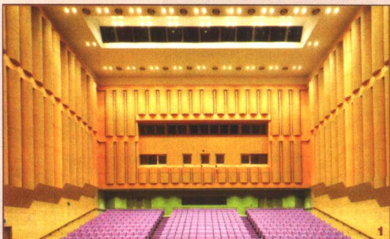
彩图 3-1 剧场：墙面柱形扩散体为卡罗姆吸声材料
