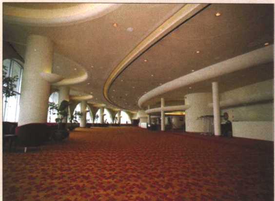
彩图 1-19 剧场休息厅：顶部喷 K-13 吸声材料
