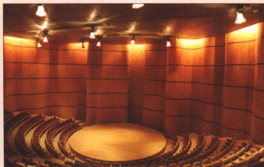
彩图 4-11 上海东方艺术中心小剧场： 1/10 声学缩尺模型
