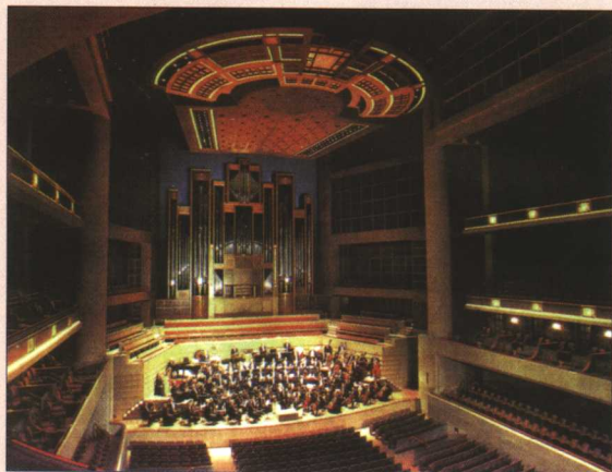
彩图 4-2 美国达拉斯麦克德莫特音乐厅: 顶部反射板重达 42t, 可升降和调节倾角
