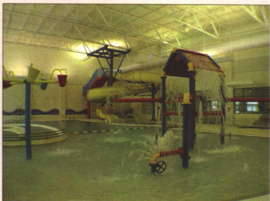
彩图 1-16 游泳馆：顶部喷 K-13 吸声材料
