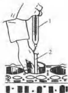
图 1-4 测量检验活塞与缸壁的间隙
