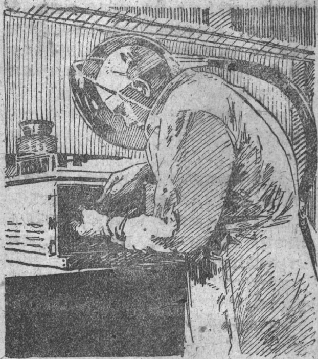
圖 6. 這是工作人員穿着防護衣在工作的情形。這種防護衣接有送風裝置，可以長時間工作。
