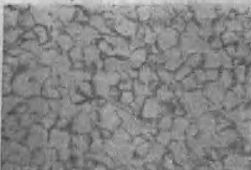
圖2 ИМ-332 的显微照片。基体晶粒3~6公忽, 很多8公忽的, 个别10公忽的(297批)。
