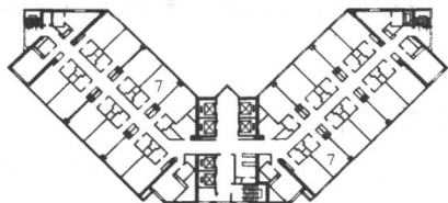
图 2-3-8 某框剪结构高层旅馆平面
