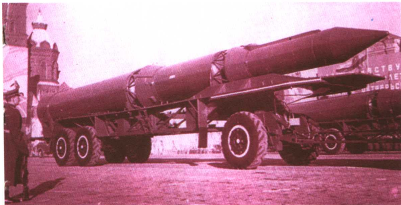
在红场游行行列中拖行的SS-13陆基洲际弹道导弹。这款导弹具有三节推进火箭，其间以开放式栏柱相连。
