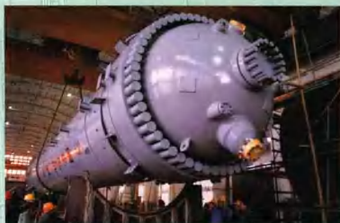
公司化机厂为金陵石化栖霞山化肥厂成功制造大化肥装置“油改煤”项目关键设备——气化炉。
