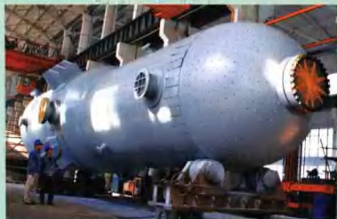
公司化机厂成功制造国内最大多层包扎高压压力容器——氨合成塔。
