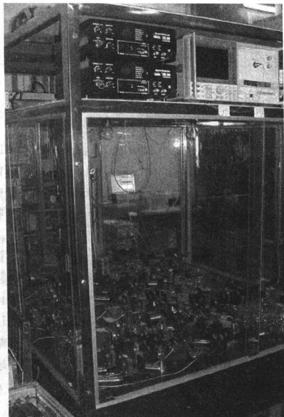
在国际制单位中，时间的单位是秒(s)。历史上曾把地球绕自己轴线转动一周所需的时间作为时间的计量标准，并定义1平均太阳秒为平均太阳日的 $(86\ 400)^{-1}$ 。1960年改为以1900年地球连续两次通过春分点所需的时间(即回归年)作为时间的标准，并定义这个时间的 $(31\ 556\ 925.974\ 7)^{-1}$ 为1秒。1967年第十三届国际计量大会决定，以铯-133原子基态两个超精细能级之间跃迁相对应的辐射周期作为时间标准，并定义1秒等于该辐射周期的9 192 631 770倍。图为中国计量科学研究院研制的铯原子束时间频率基准装置，350万年误差不超过1秒。
